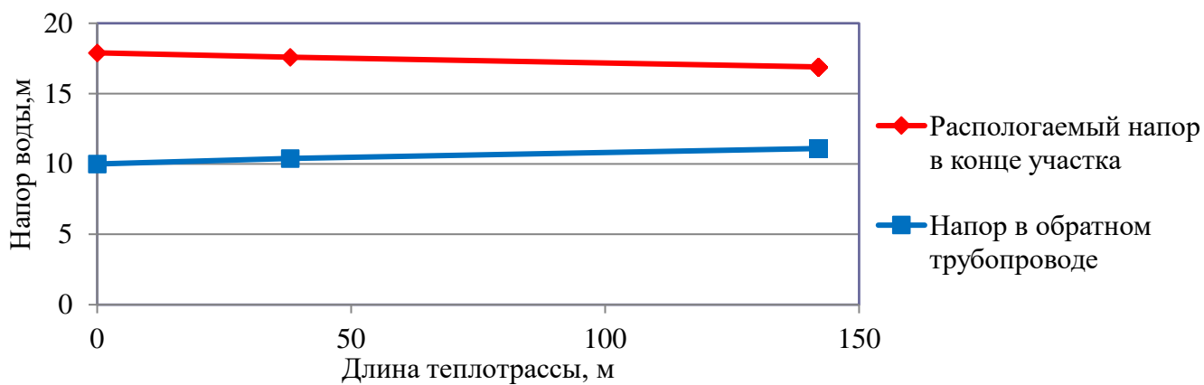
Рисунок 2.7 – Пьезометрический график тепловой сети Котельной №1 с. Кичигино
