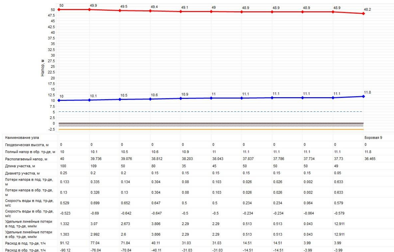
Рисунок 2.41 – Пьезометрический график от Котельной п. Нагорный до самого удаленного потребителя в аварийной ситуации по ул. Боровая
